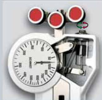
fig. 1: einstellbare Dämpfung
