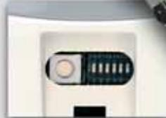
fig. 3: DIP-Schalter für Einstellungen durch den Benutzer, z.B. Anzeigintervalle
