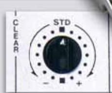
fig. 1: Anwenderjustierung (Field adjustment): Kundenseitiges Anpassen der gespeicherten Justierkurven in  $\pm 1.5\%$  Schritten, falls das Messgut vom SCHMIDT-Justiermaterial abweicht
