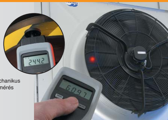
testo 465 és testo 470, érintésmentes (optikai) fordulatszám-mérés forgó alkatrészen
